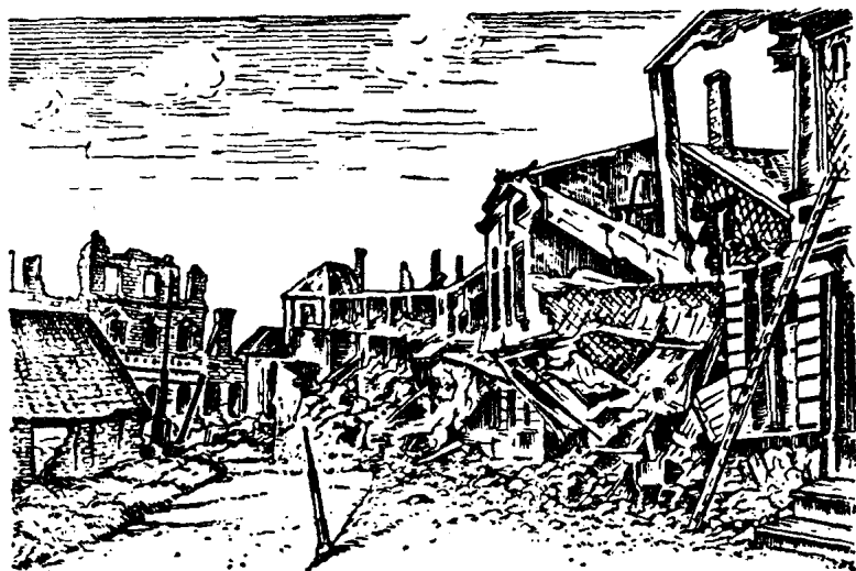
圖 1. 由於地表下降而引起地表建築物破壞的情況
