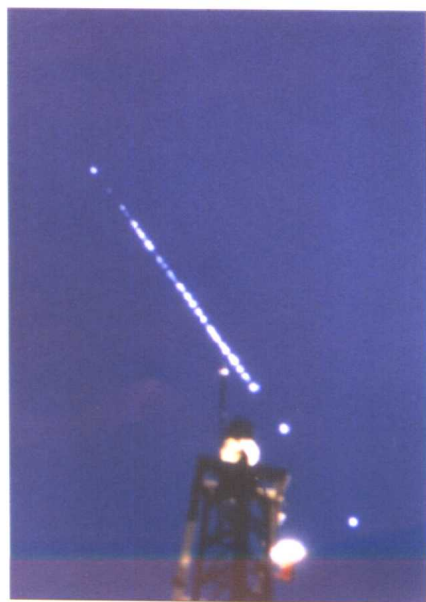
图 8-12 晴天时在塔顶处产生的等离子体通道(王道洪提供)
