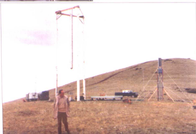
图 9-1a 80 年代美国引雷试 验现场(左方为模型导弹及测 试车, 右方为法国发射架)
