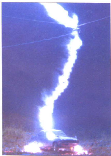
图 7-9 人工引雷击中小汽车(日本角绅一提供)
