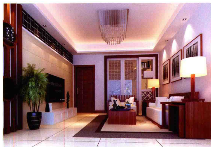
装饰方柱 石膏板造型拓缝刷彩色乳胶漆
