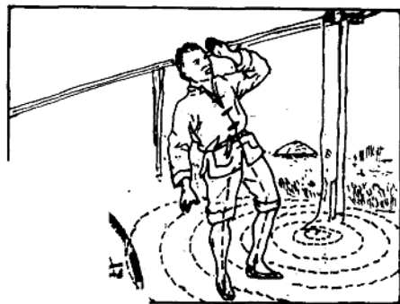
图 1-4 跨步电压触电
