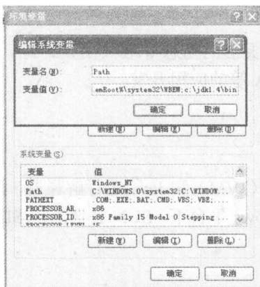
图 1-2 在控制面板中设置 JDK 的默认 path 的值
