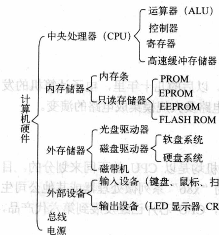
图 1-1 微型计算机的硬件组成
