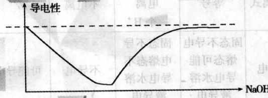
[解析] HCl → NaCl, 1 mol HCl生成1 mol NaCl, 由于NaOH(aq)带进了水,故[NaCl] < 1 mol/L 导电性减弱, 完全反应后, 再加NaOH(aq)由于导电性 NaOH(aq) = HCl
