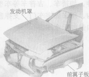
图1-7 前翼子板与发动机罩
