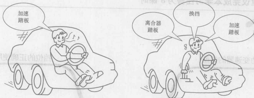
图 1-1 手动变速器与自动变速器的区别的示意图
