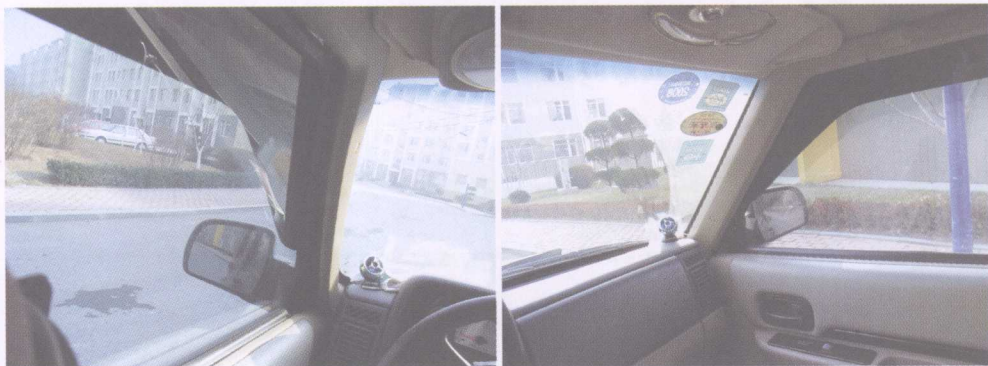
图 1-3 A 柱对驾驶员视野的限制
