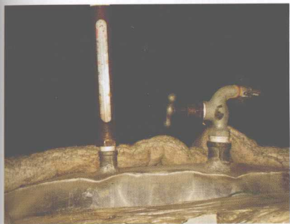
图2-8 仓式简易灭菌灶顶部装有温度计及出气阀
