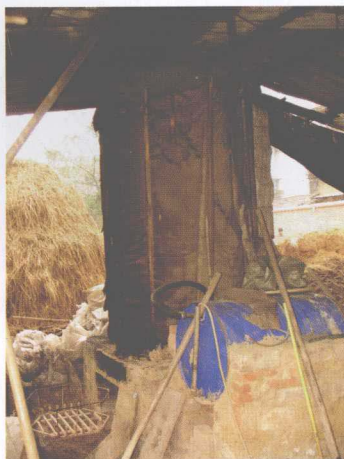
图2-7 用铝板焊制的仓式简易灭菌灶
