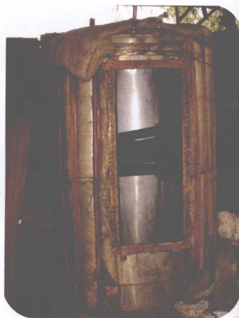
图2-6 用铝板焊制的仓式简易灭菌灶
