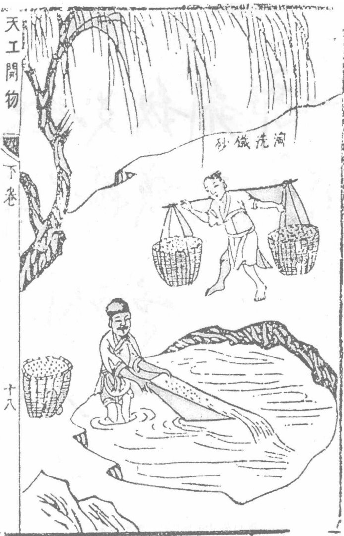
宋应星《天工开物》中的洗矿图
