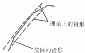
图 1-6 齿形的包络造形误差
