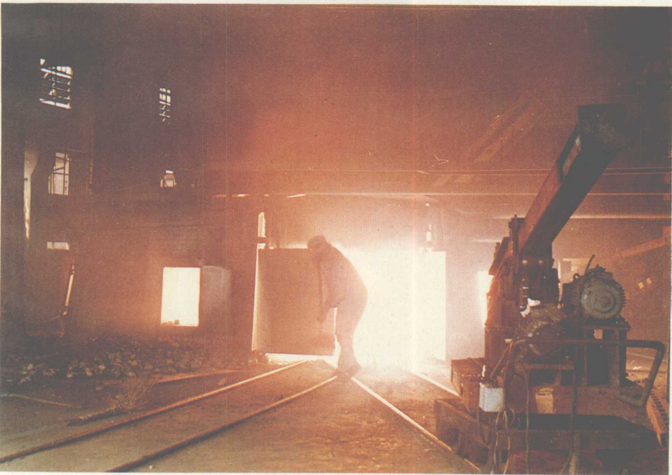
湖南铁合金厂自行 设计、安装于1976年投 产的全国最早的矮烟罩 硅铁电炉。
