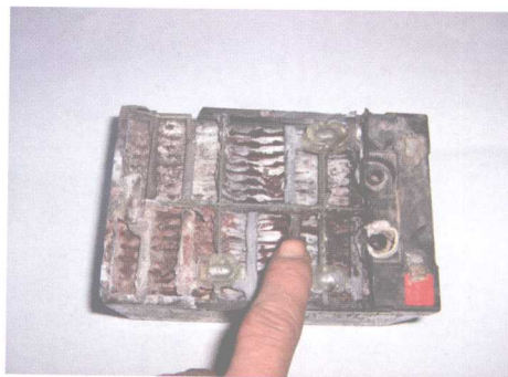
电池硫化后堵塞电循环
