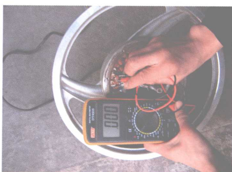
用万用表测量电机内部霍尔元件好坏
