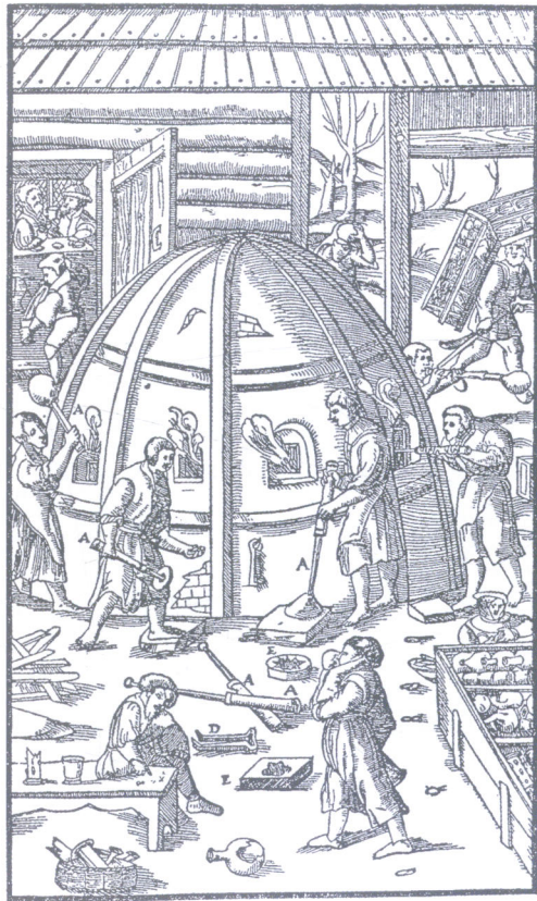
图1.1.2 熔融玻璃, 关于采矿和冶金的十二书 Dere metallica中的雕版图, Georgius Agricola (1494~1555), 巴塞尔, 1557 年
