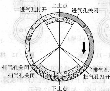
图 1-15 二冲程发动机配气相位图
