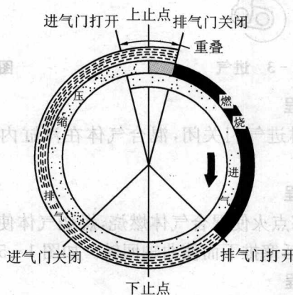
图 1-7 四冲程发动机配气相位图
