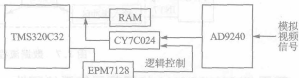
图 1.5 视频数据采集处理部分原理框图
