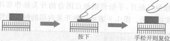
图 1.6 自动复位型按钮开关
