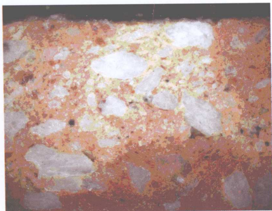
图版 19 颐和园琉璃瓦样品断面的 矿相显微镜照片
