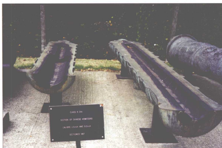
图版 15 两门中国青铜-铁炮的纵截面
