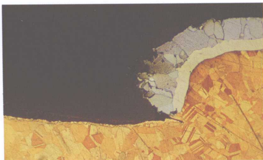
图版 9 热镀锡模拟实验样品金相照片 (同图版 8, \text{FeCl}_3 浸蚀, \times 100 )
