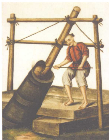
图版 13、图版 14 炮的模范制作和铸造
