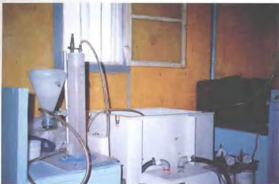
煤层含气量测试设备及流程
