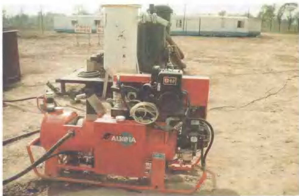
煤层气井注入/压降测试
