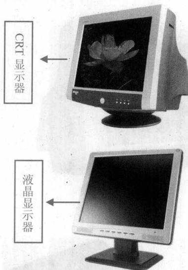
显示器的面板上有电源开关和用来控制显示器亮度和对比度等参数的调节旋钮或按钮。背面板上有一条显示器信号线和一条显示器电源线。
