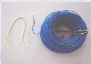
彩图2-4 单芯铜线连接的电加温线
