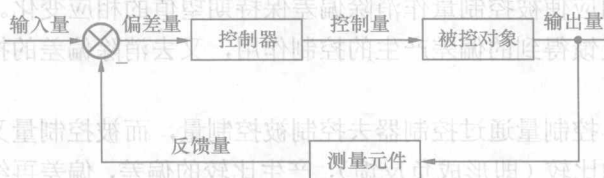
图 1-3 闭环控制系统
