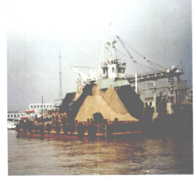
混凝土搅拌船
