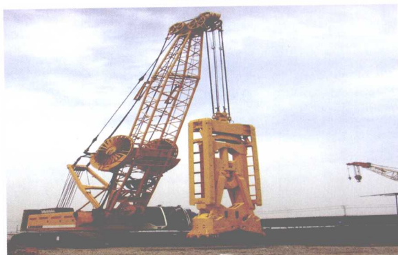
地下连续墙成槽机
