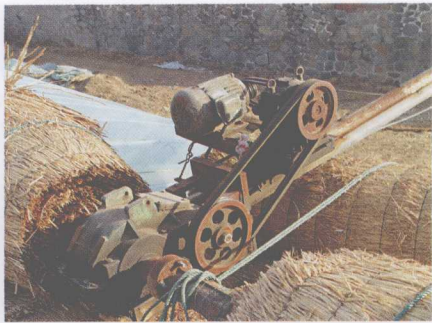
彩图 14 卷帘机组首部的电动机及减速器
