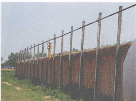
彩图 12 安装在温室后墙外的卷帘机组及传动轴
