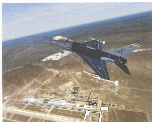
彩图 IX 高分辨率地形纹理贴图，它需要一个非常巨大的图像数据库，使用裁减图进行绘制，目的是减少一次所需要的数据总量(此图经 Aechelon 技术公司授权使用，这幅图是在 SGI 硬件上由 C-Nova/C-Radiant 图像生成器生成的)
