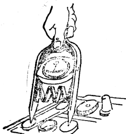
图1—4 用放电叉检查蓄电池的放电程度
