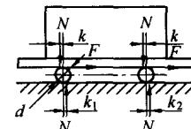
重物压在圆辊支承的平台上移动, 每个圆辊承受的载重为  $N$ 。克服一个辊子上摩擦阻力所需的牵引力  $F$
