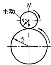
两个具有固定轴线的圆柱, 其中主动圆柱以  $N$  力压另一圆柱, 两个圆柱相对滚动。主圆柱上遇到的滚动阻力矩为
