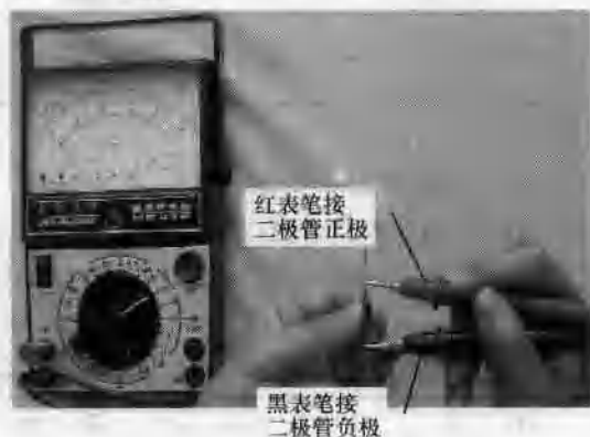
图 1-8 测量二极管的反向电阻
