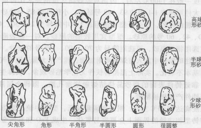
图 1-2 原砂粒形分类法
