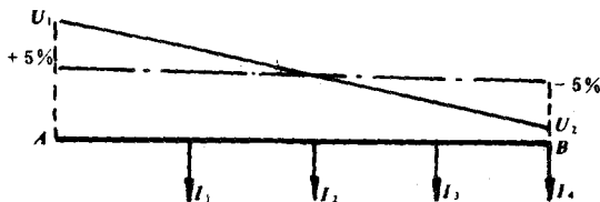
图 1-2 电气设备受电电压
