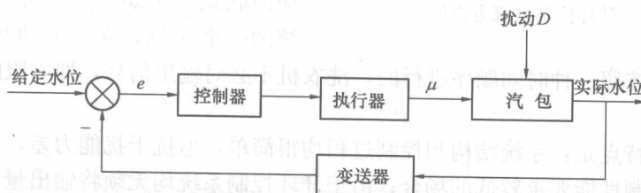
图 1-2 自动控制系统组成框图
