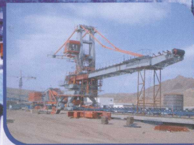
英立特1500/1000 30斗轮机堆取料机电控系统设计、制造及调试
