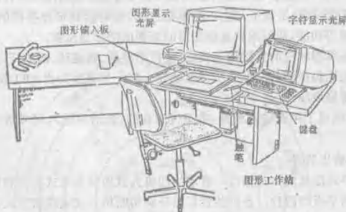
图 1.4 CAD 系统硬件的组成
