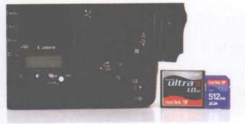
▲ 同时支持CF I/II型和SD卡，可作独立存取，或者同时储存至两张卡作备份。如果两张卡的容量不同，相机便会以容量较少的那张为准，所以最好使用两张相同容量的存储卡。
