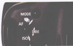
▲ 使用EOS-1系列采用了多年的操控方式，利用三个按钮可以组合成六种不同操控方式。对于职业摄影师来说，拍摄时可以更快，单靠手指感觉也可以操作自如。
