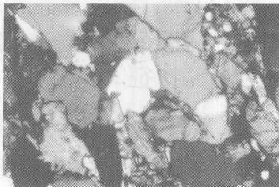
图 2-1 特低渗透长石砂岩，石英颗粒次生加大，长石溶蚀，颗粒线接触（显微照片， \times 100 倍，长 6 1 ，S111 井）
