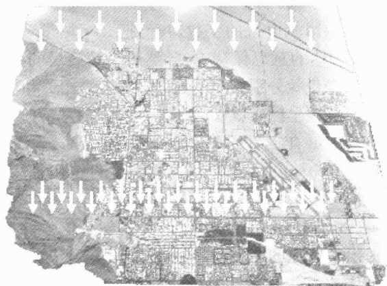
图 1.3.1 遥感影像的采样间隔与地物的尺度
