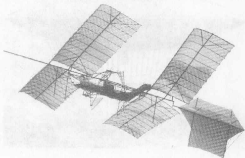
图1-7 兰利和曼利合作研制的载人飞机“空中旅行者”，发动机是曼利亲自研制的一种新型5缸星形水冷汽油机
