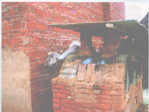
用油桶改制成的蒸汽发生器进行二次发酵加温
