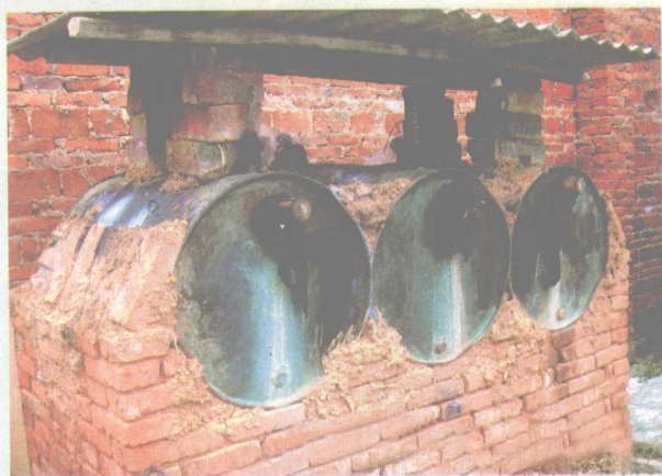
用油桶改制成蒸汽发生器
