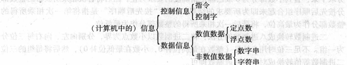
数值型数据的编码要解决三个问题：①恰当地选用的数字符号及组合规则；②正确地给出小数点的位置；③正确地表示出数的正、负号。
