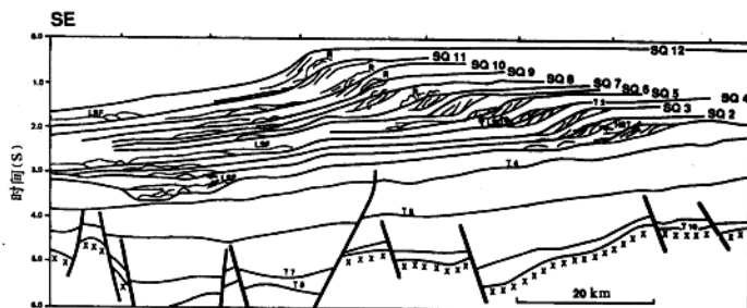
图 1-6 南海北部边缘新第三纪具陆架坡折的层序地层样式 (T 1 界面之上为新第三系) (据陈志勇等, 1990)
