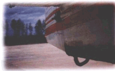
彩图⑮ 后机身尾橇处腐蚀 严重
