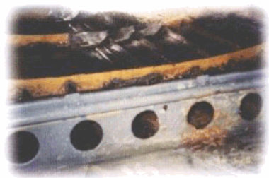
彩图⑪ 机身内下壁、框缘长桁腐蚀严重
