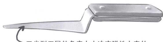
刀尖到刀尾的角度大小决定弹性力度的分布。可用大型钢剪切成需要的形状
