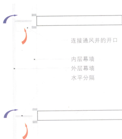
图 1-9 箱井式幕墙剖面图， 箭头表示气流由箱式窗流入 公共通风井的路径
