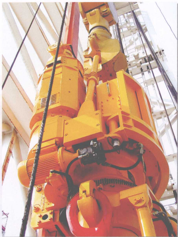
局多种经营企业自主研制的 DQ-40DB 顶部驱动 钻井装置获 5 项自主知识产权，达到国际领先水平
