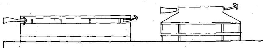
風對建築物的平屋頂，坡度 7:12 的斜屋頂或坡度超過 7:12 的下風斜屋面產生側向負荷（壓力）及上揚力（風昇力）。( uplift force )
