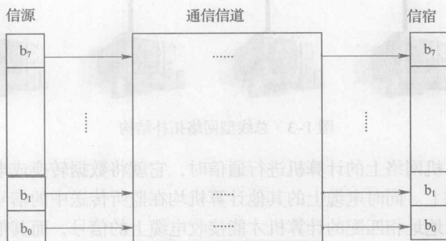
图 1-2 并行通信数据传输示意图
