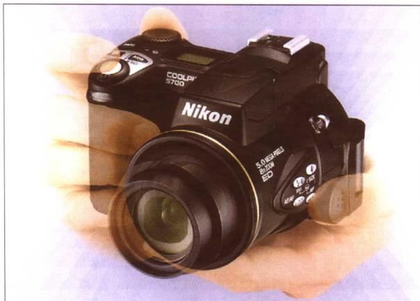
反光原理的优势在顶级的数码相机中通过其与照片没有视差的取景器示图与监控得到充分的体现。这些顶级相机要么通常配有折叠式反光镜(头)和反光棱镜,要么除了液晶显示屏之外还配有一个电子放大取景器(EVF)(如图所示尼康 Coolpix 5700)。
