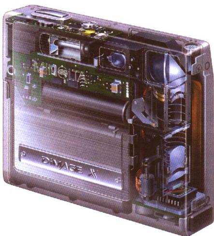
数码相机变得越来越小，越来越轻。有些微型化成果所采用的建设性的方案往往令人咋舌。比如美能达Dimage X 中的可变焦镜头垂直放置在相机体中，这种结构令人想起潜望镜的构建方式。
