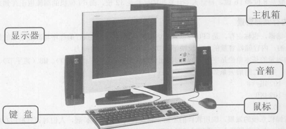
图 1-4 计算机的硬件组成
